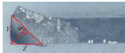
图 10 垂直深度的定义(缺口型 FOD)
